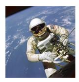
En 1965, la NASA a expérimenté un propulseur portatif constitué de deux bouteilles d'air comprimé. Edward White est le premier astronaute américain ayant réalisé une sortie extravéhiculaire en utilisant ce propulseur.
