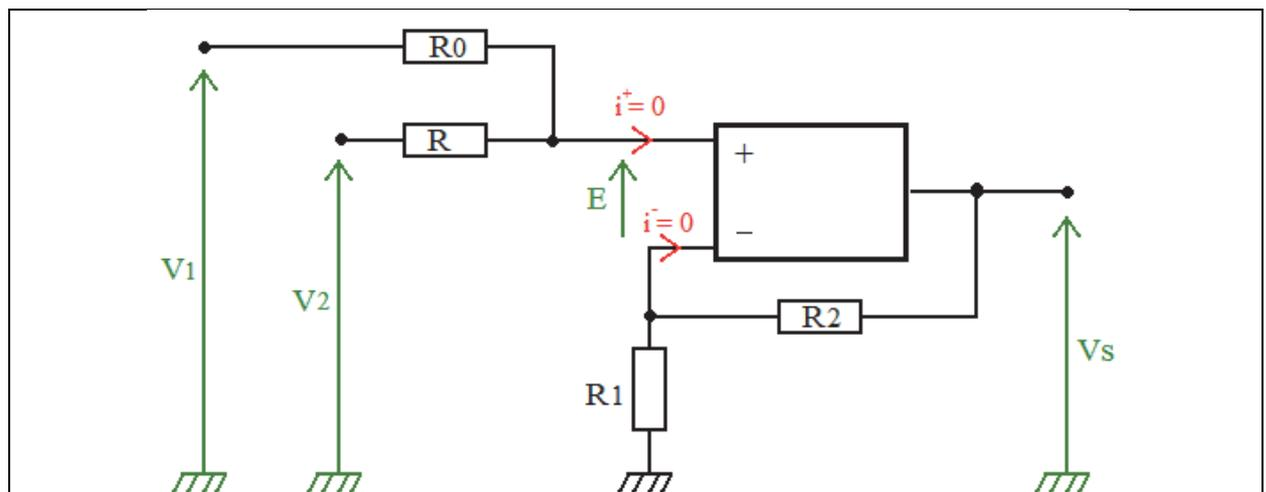
$V_1$  = tension aux bornes du microphone
