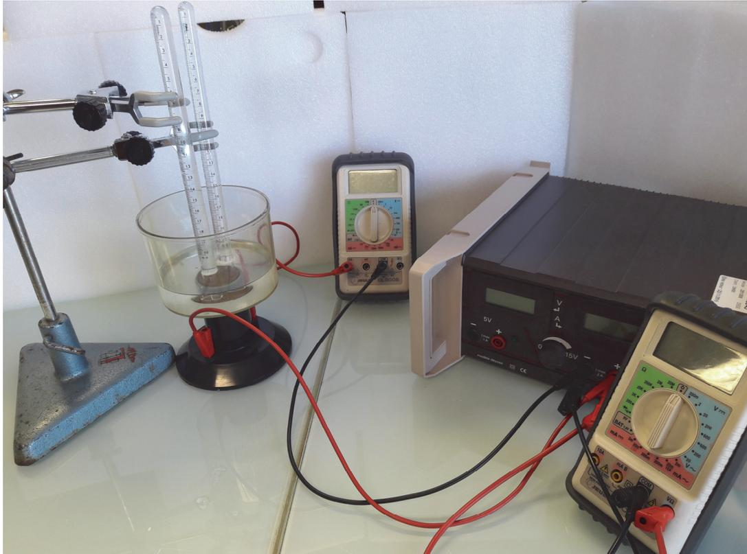
Lorsqu'un électrolyseur est alimenté par un générateur délivrant une tension  $U$  (exprimée en volts), il est parcouru par un courant d'intensité  $I$  (exprimée en ampères). L'énergie  $W_E$  totale reçue par l'électrolyseur (exprimée en joules) pendant une durée  $\Delta t$  (exprimée en secondes) est :
