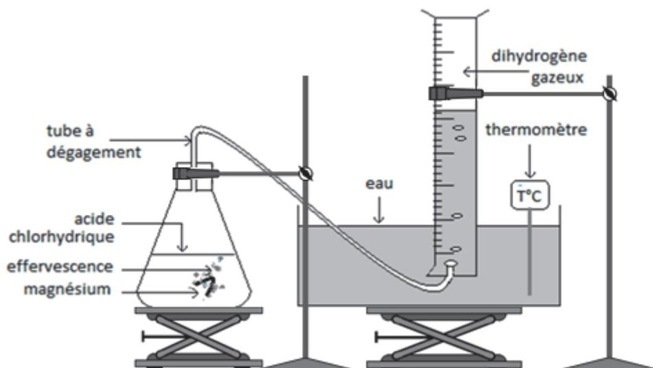
L'erenmeyer est placé sur un support élévateur ; le cristallisoir l'est également afin de faciliter le positionnement du tube à dégagement dans l'éprouvette.
