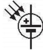
Lorsque la cellule reçoit de la lumière, une tension électrique apparaît à ses bornes. Elle se comporte alors comme un générateur.
