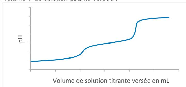
On note  $V_E$  le volume équivalent mesuré au deuxième saut de pH.
