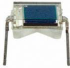
Une photodiode est un dipôle électrique polarisé parcouru par un **courant dont l'intensité est proportionnelle à l'éclairement qu'il reçoit d'une source lumineuse**. Il s'agit donc d'un détecteur de lumière.
