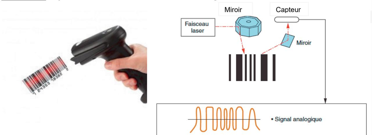
Le faisceau laser émis par la diode laser est réfléchi par le miroir polygonal en rotation et balaie le code-barres. La lumière réfléchie est captée par l'élément récepteur sensible à la lumière. La forme de l'onde du faisceau lumineux réfléchi est représentée dans l'illustration ci-dessus sous forme de signal analogique. Le signal subit une conversion analogique/numérique afin de pouvoir délimiter clairement les deux types de zones (espace blanc et barre noire).
