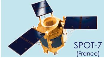
Le satellite SPOT 7 forme, avec le satellite SPOT 6, un réseau satellitaire permettant l'observation et la cartographie de la surface terrestre. Les instruments embarqués permettent d'atteindre une résolution spatiale de 1,5 m. On donne ci-dessous quelques caractéristiques techniques :
