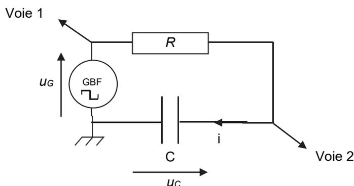
Le dipôle constitué par le conducteur ohmique et le condensateur, nommé « dipôle RC », est alimenté par une tension-crête-à-crête d'une amplitude de 5,0 V fournie par un GBF (Générateur Basse Fréquence).
