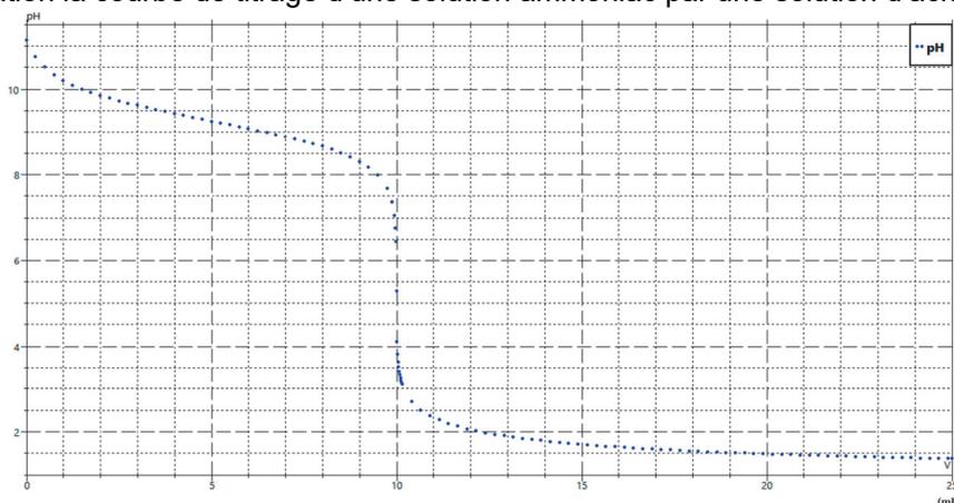
Titration de 10,0 mL de solution d'ammoniacque de concentration  $0,10 \text{ mol} \cdot \text{L}^{-1}$  par une solution d'acide chlorhydrique de concentration  $0,10 \text{ mol} \cdot \text{L}^{-1}$ .
