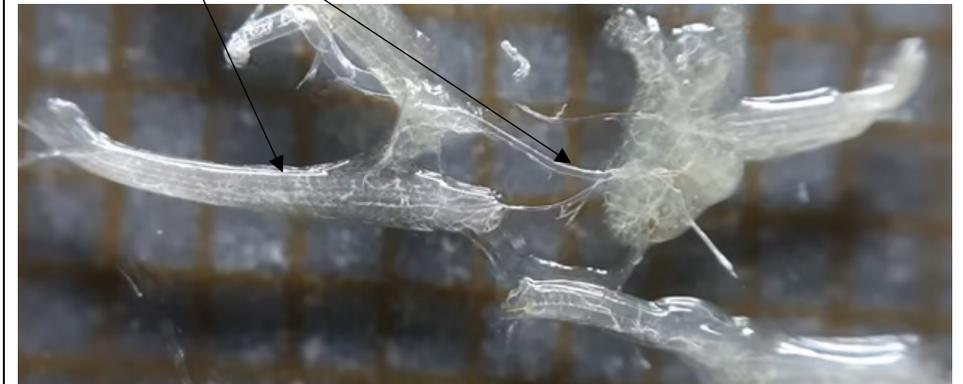
Fibres dilacérées, observées à la loupe binoculaire. Les carreaux du papier millimétré visible en arrière-plan mesurent 1 mm de côté.
