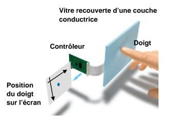
Lors du contact d'un doigt (conducteur) sur la vitre, la surface se décharge localement, induisant une diminution de tension qui permet au contrôleur de déterminer la position du contact. Nous considérons, pour simplifier, que le contact du doigt sur la vitre modifie la charge d'une seule surface élémentaire.
