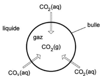
Dans le cadre de cette modélisation, la capture de  $\text{CO}_2$  se fait uniformément sur la surface de la bulle. Le volume de la bulle augmente lors de son ascension parce qu'elle capte le dioxyde de carbone dissous dans la phase liquide.
