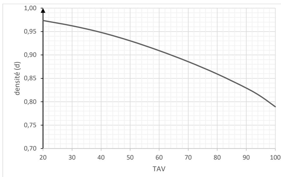
Graphique représentation les variations de la densité d'un mélange eau / éthanol en fonction du titre alcoométrique volumique (TAV) à la température de 20°C
