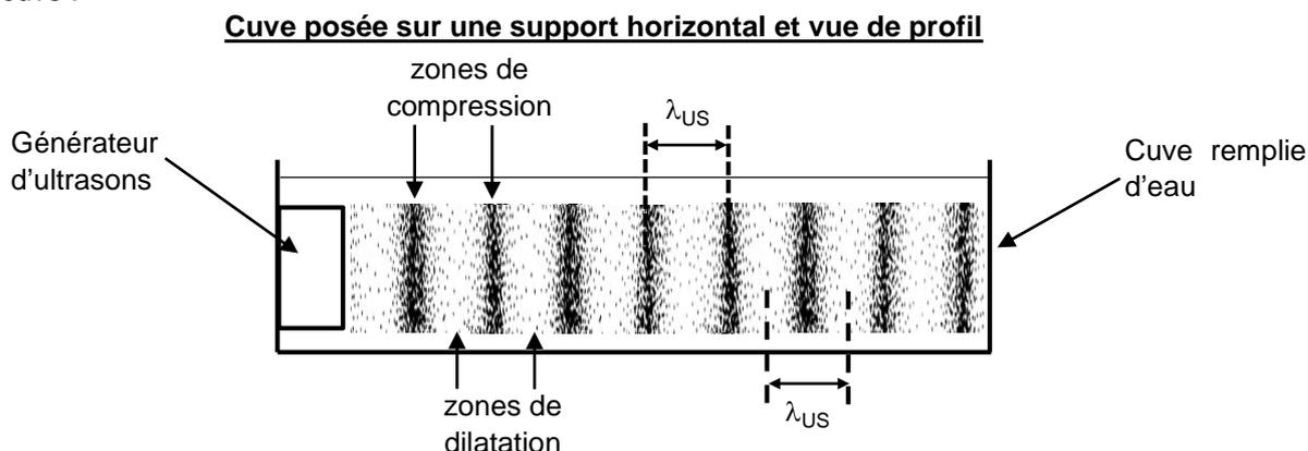
Si un faisceau laser monochromatique est dirigé **perpendiculairement** au plus grand côté de la cuve, cette configuration spatiale de l'eau se comporte comme un « réseau interférentiel » : les zones de compression et de dilatation successives ont le même comportement que l'alternance des fentes et des obstacles qui les séparent dans un réseau.
