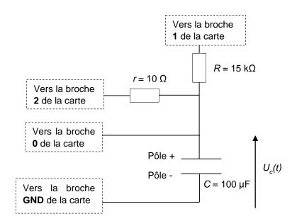
Il est impératif de respecter la polarité du condensateur électrolytique lors de son branchement dans le circuit.
