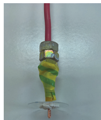
Extrémité inférieure de la tige mobile, avec lest et rondelle
