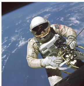
En 1965, la NASA a expérimenté un propulseur portatif constitué de deux bouteilles d'air comprimé. Edward White est le premier astronaute américain ayant réalisé une sortie extravéhiculaire en utilisant ce propulseur.
