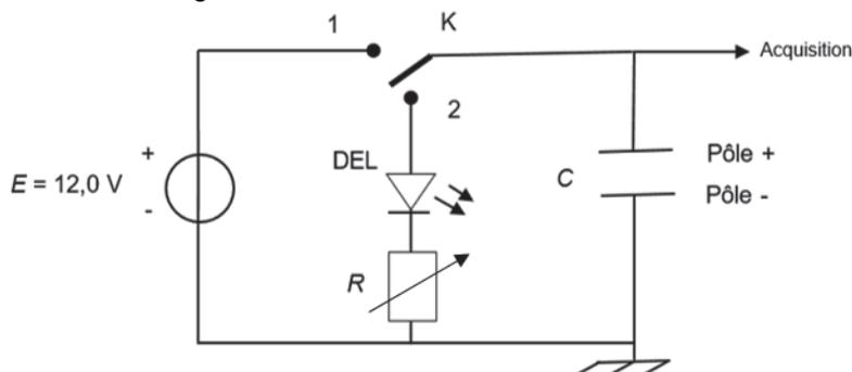
**Attention**, si le condensateur est polarisé, il faut **respecter les bornes + et -** pour qu'il soit correctement branché. De même, en ce qui concerne la Diode Électro Luminescente (DEL), elle doit être branchée en respectant le sens indiqué sur le schéma.
